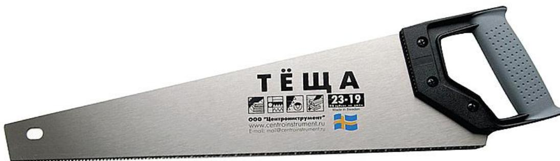
Рис. 4.5 пила по дереву с мелким зубом.
